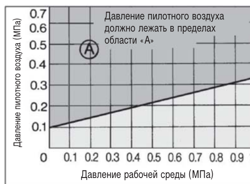
Зависимость давления пилотного воздуха от давления рабочей среды
